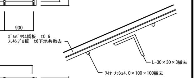
トプライト鋼板葺き断面図 S=1:2
