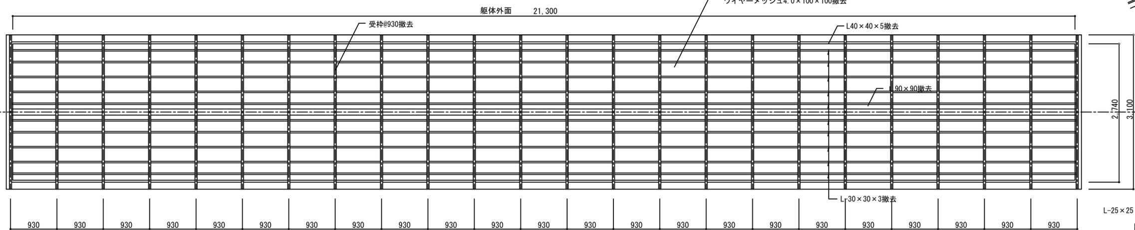
トプライト 鋼板葺き部平面図 S=1:50
